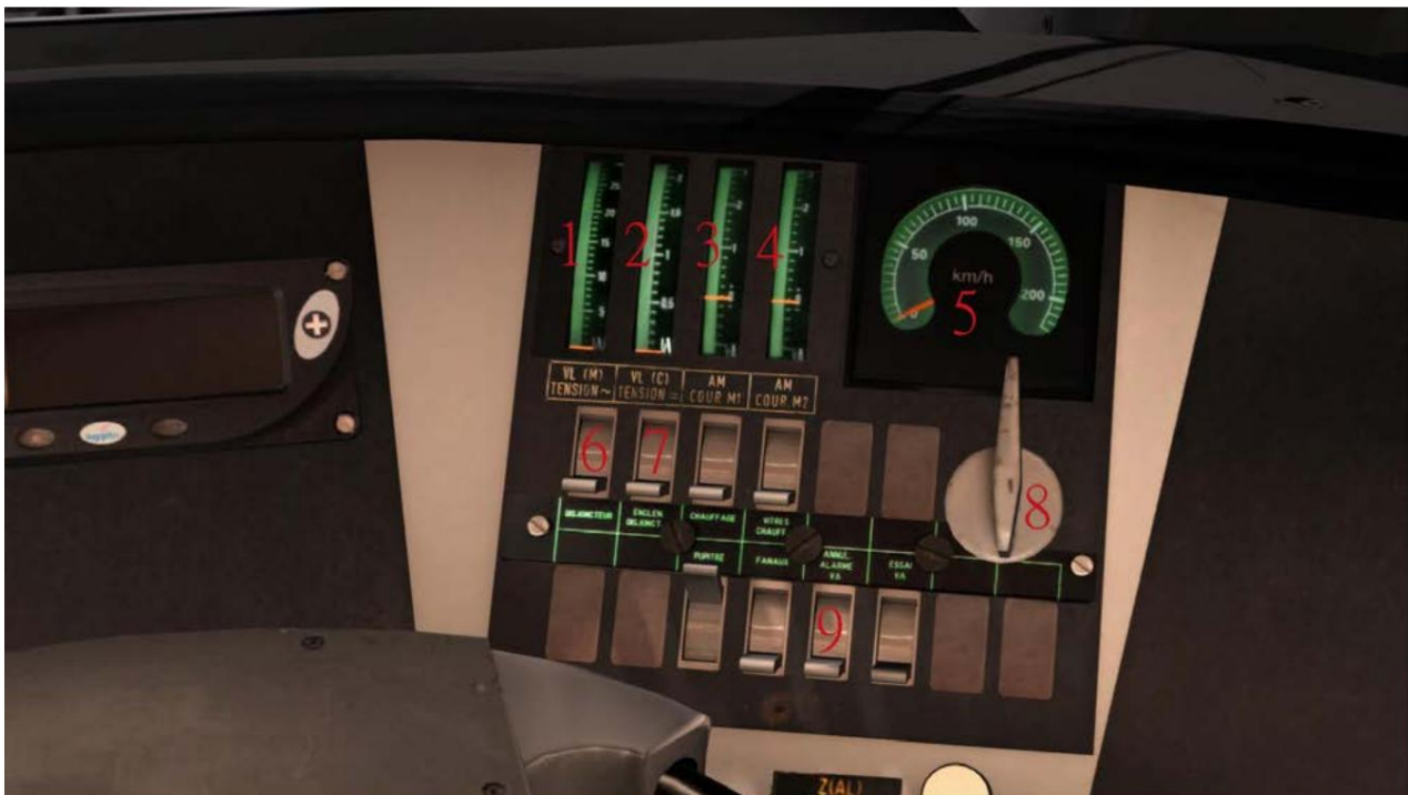
1: Einphasen-Voltmeter 2: DC-Voltmeter 3/4: Motor-Amperemeter 5: aufgesetzter Kurzwahlschalter (VI) 6: Leistungsschalter 7: Leistungsschalteingriff 8: Hebelkastenschalter 9: Deaktivierung des automatischen Standby
