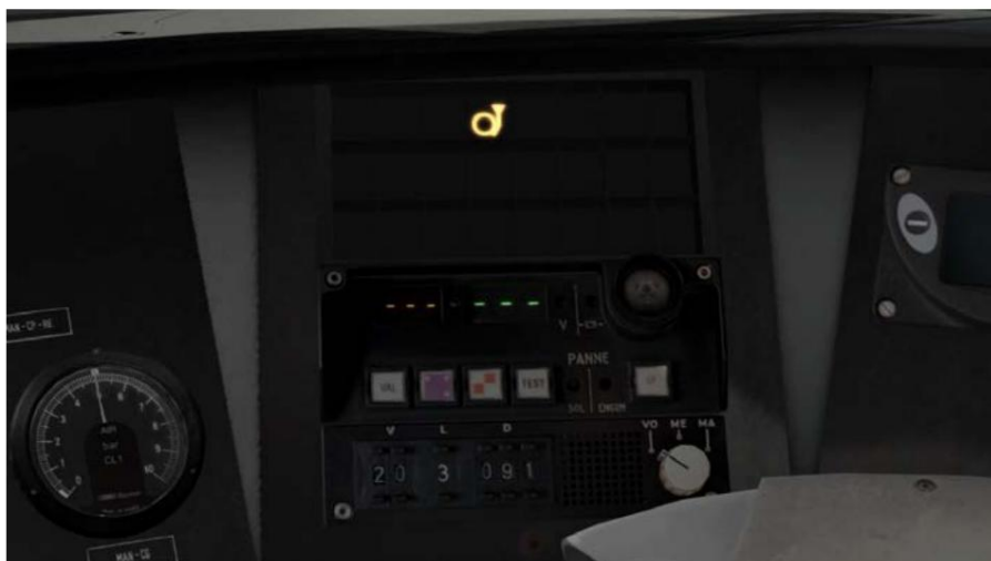
Das Piktogramm LS-SA leuchtet während des automatischen Sandstrahlens
